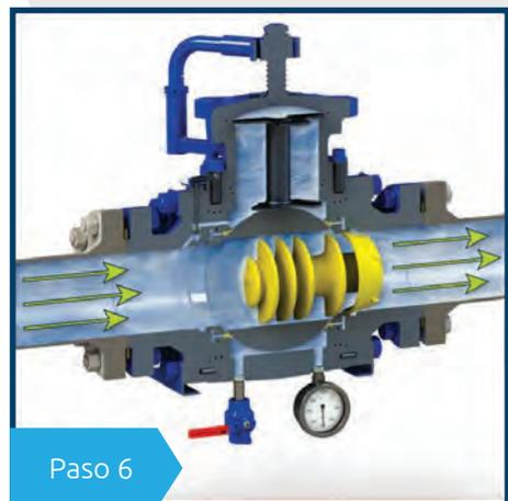
Reposicionar el pasador de seguridad en la LIP. Abrir la válvula Argus en la posición de abierto.
