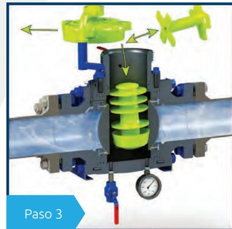
Remover el tapón de entrada y el contrapeso. Insertar el raspador en la válvula Argus.
