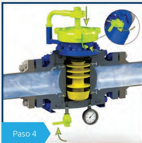
Reinstalar el contrapeso, luego el tapón de entrada y finalmente el seguro en la válvula de alerta de presión.
