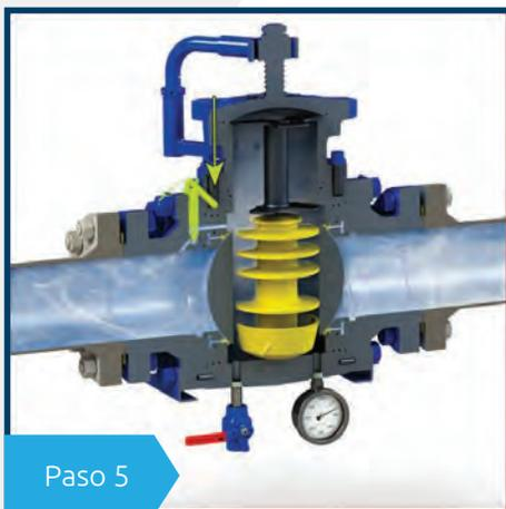
Cerrar las válvulas de venteo y/o drenaje. Remover el pasador de seguridad en la línea igualadora de presión (LIP). Presionar hacia abajo la palanca de la LIP.
